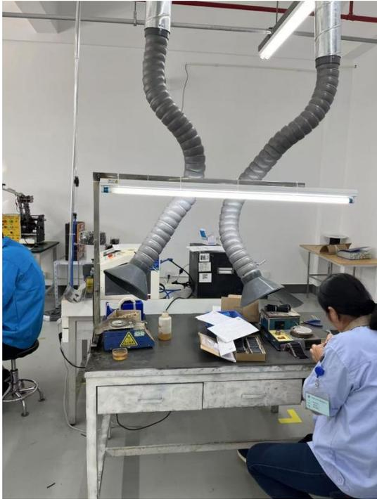
插片焊接废气收集
